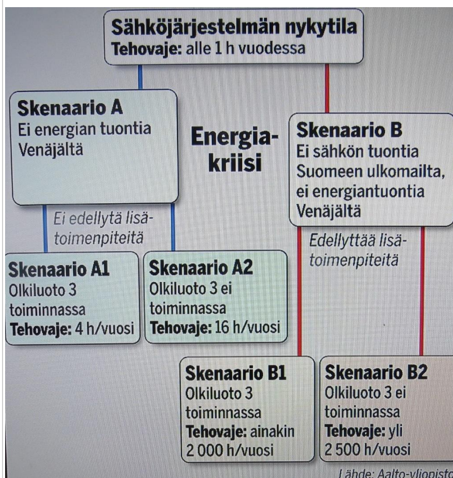
Kuva 5.1.1 Sähkön toimitusvarmuus eri tilanteissa.
