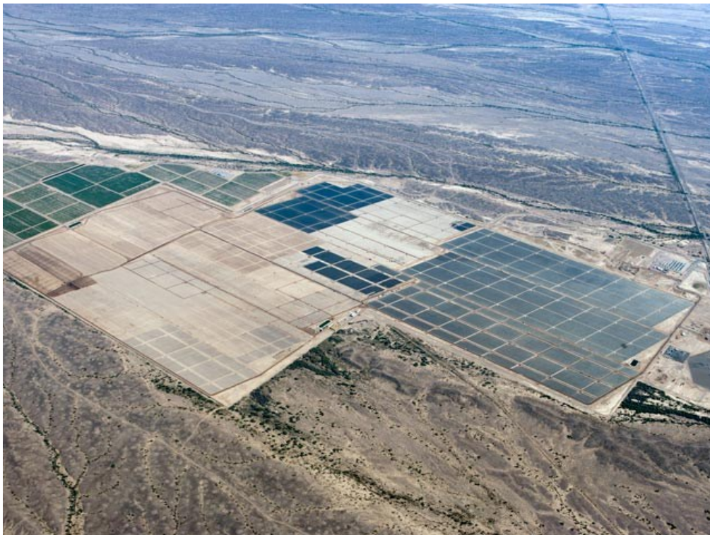
Kuva 2.1.7 Aqua Calienten 290 MW:n tehoinen aurinkokennovoimala valmistuu vuonna 2014. Voimalan vuosituotanto on 626 GWh ja pinta-ala 1000 ha.
